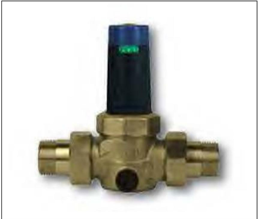
Federbelastete Druckminderer arbeiten nach dem Kraftvergleichssystem. Das heißt, einer Membrankraft wirkt die Kraft einer Sollwertfeder entgegen. Sinkt infolge einer Wasserentnahme der Ausgangsdruck und damit die Membrankraft, so öffnet die nun größere Federkraft das Ventil. Der Druck auf der Ausgangsseite wird wieder höher, bis erneut ein Gleichgewichtszustand zwischen Membran- und Federkraft erreicht ist.
